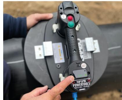
Einfache Bedienung der Vakuumpumpe PUMP.
