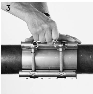
Verschluss einhaken. Schrauben abwechselnd und gleichmäßig anziehen.
