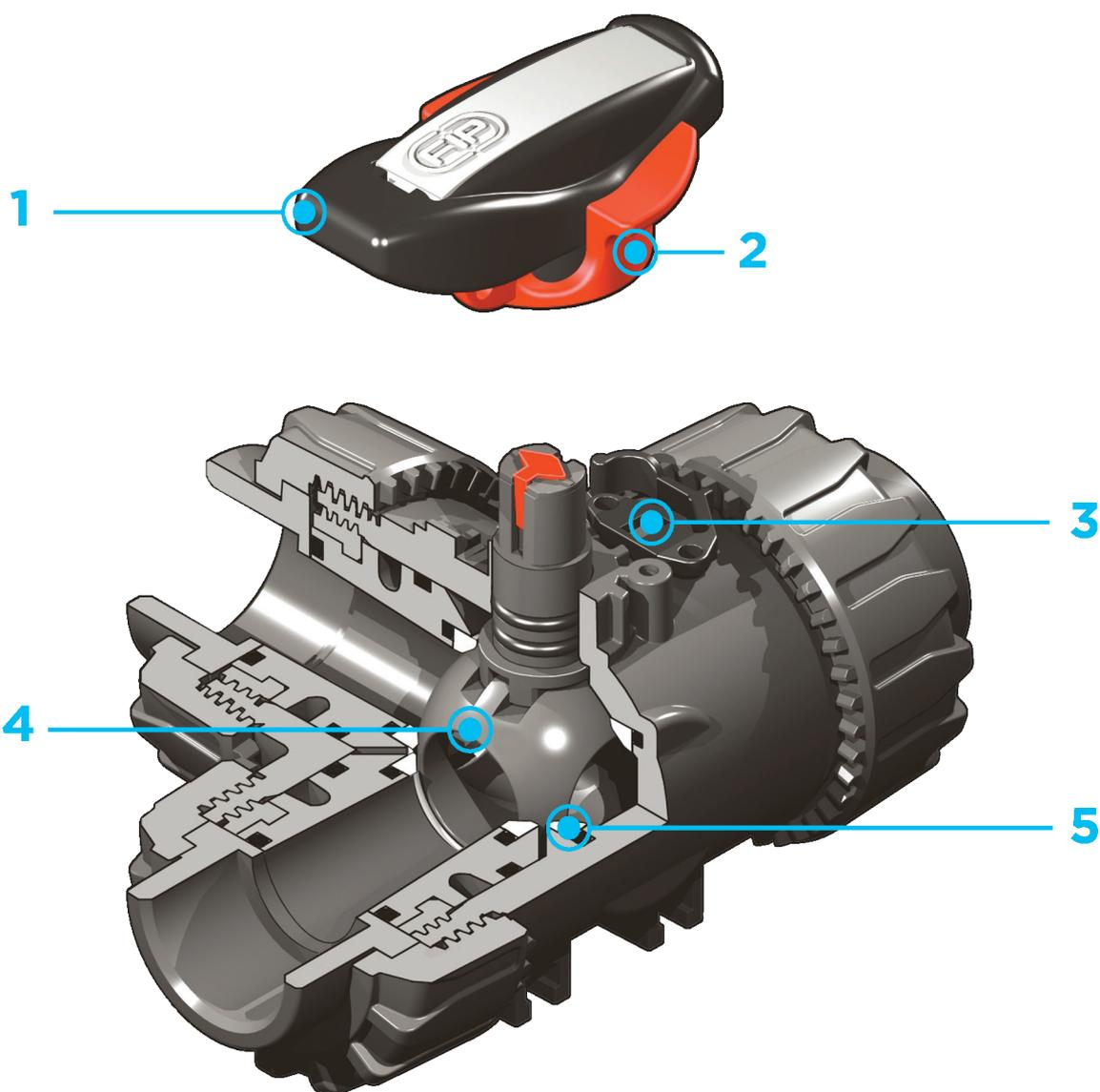
**1** Maniglia ergonomica in HIPVC dotata di chiave estraibile per la regolazione del supporto delle guarnizioni di tenuta della sfera. Possibilità di installare il **limitatore di manovra LTKD** (disponibile come accessorio) che consente la rotazione della sfera e della maniglia solo per angoli prefissati di apertura o chiusura a 90° o 180°
