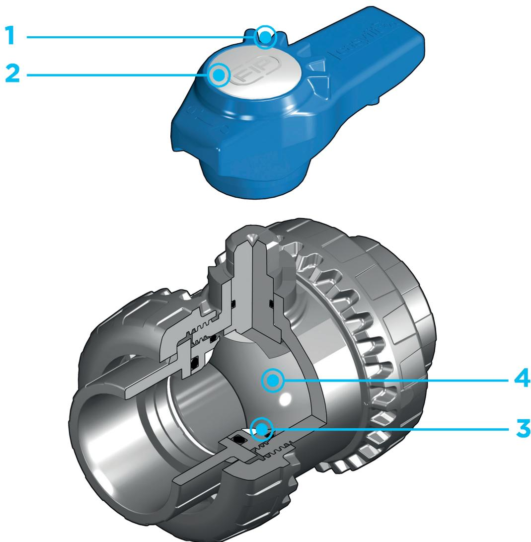
**1** Maniglia ergonomica multifunzione Easyfit bipozionabile con comando per registrazione del serraggio delle ghiera e utilizzabile come chiave per la regolazione del supporto delle guarnizioni di tenuta della sfera. L'uso della maniglia è particolarmente indicato per operazioni di **manutenzione** ove si operi in **spazi limitati** e di difficile accessibilità
