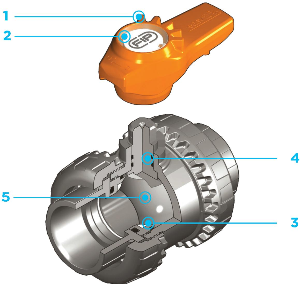
**1** **Maniglia ergonomica multifunzione Easyfit** bipozionabile con **comando per registrazione del serraggio delle ghiera** e utilizzabile come chiave per la **regolazione del supporto delle guarnizioni di tenuta della sfera**. L'uso della maniglia è particolarmente indicato per operazioni di **manutenzione** ove si operi in **spazi limitati** e di difficile accessibilità
